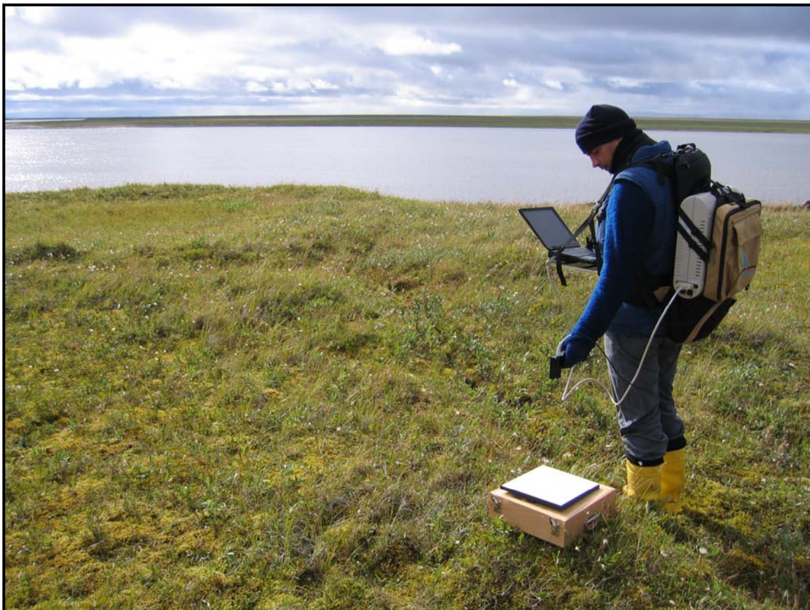
Abb.14: Nutzung des FieldSpec®FR im Lena-Delta (August 2005). Referenzmessung mit einer Weißreferenztafel (Spectralon®) (im Bild unten) (Foto: G.Grosse)
