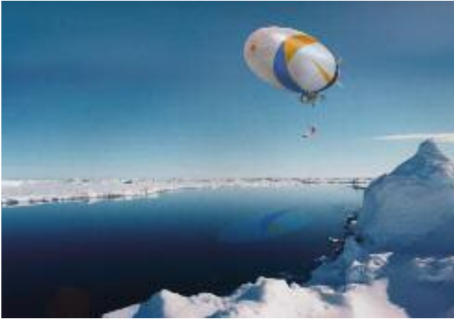
Künstlerische Fotomontage der PoleAirship-Idee von Eisdickenmessungen über dem Nordpol. Der EM-Bird wird von dem Luftschiff über das Eis geschleppt.
