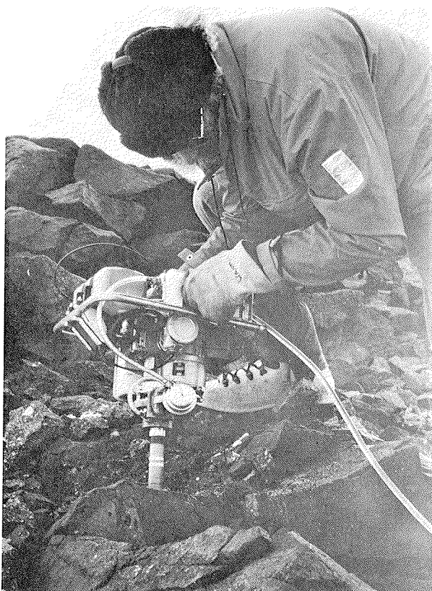
Wastl Wörgötter beim Bohren von Proben für paläomagnetische Untersuchungen Fotos: K. Weber
