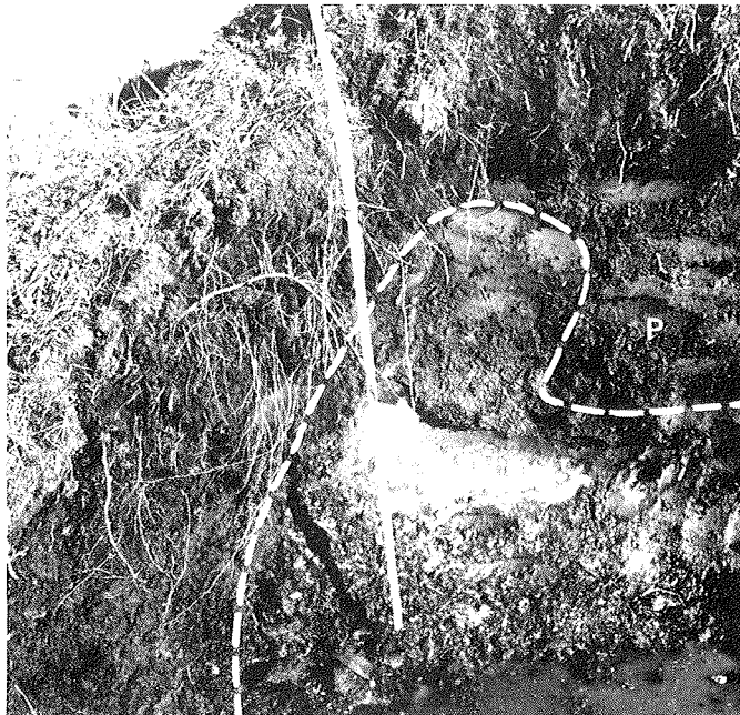
Abb. 5: Detailaufnahme eines Eiskerns. Nur das luftreiche Eis im Zentrum des Eiskerns (Umriß gestrichelt) erscheint weiß. Die gefrorenen Torfschichten (p) enthalten zahlreiche kleine Eislamellen.
