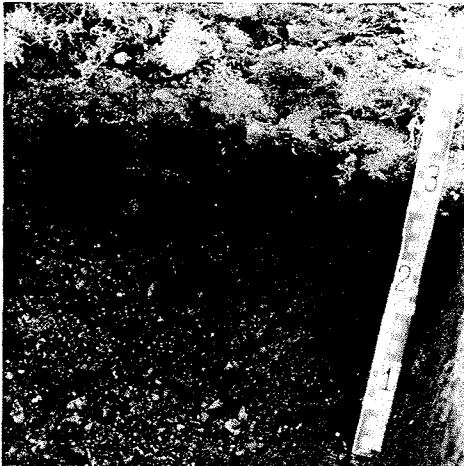
Abb. 7: Skelettreiche Antarktische Braunerde auf Plagioklas-Olivin-Basalt unter Flechten- und Moostrundra (Fildes-Halbinsel; ca. 45 m ü. M.). Die oberen 10–15 cm sind durch Auffrierprozesse relativ mit Feinmaterial angereichert, an der Oberfläche Mikropolygone entwickelt. Humusgehalt im A_h -Hor.: 4,5%; pH KCl: 4,8.
