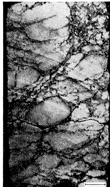
Abb. 18. Typischer Knollenanhydrit. Die einzelnen Knollen sind von grünlichen dolomitischen Säumen umgeben (Probe 225/29/2). Maßstab entspricht 1 cm.
