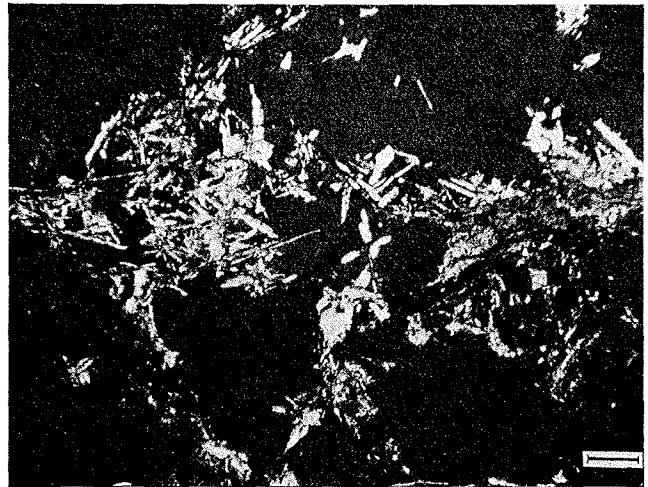
Abb. 13. In Steinsalz (grau) nesterartig eingewachsener nadeliger Polyhalit (hell). Dünnschliff der Probe 225/29/2. Teilweise gekreuzte Nicols. Maßstab entspricht 0,5 mm.
