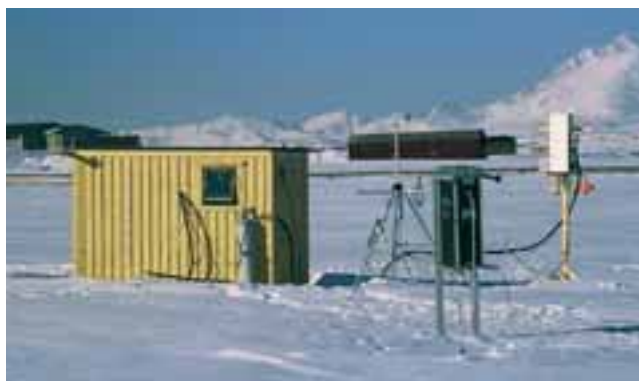
Messgeräte von der Universität Grenoble erfassen die Quecksilberbelastung von Schnee und Atmosphäre während des arktischen Frühlings. (Foto: Christophe Ferrari)
