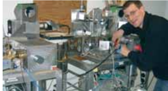
Die technische Wartung der Mikrowellenradiometer zur Bestimmung von Atmosphären gasen wie Wasserdampf oder Ozon ist Aufgabe des Stationsingenieurs. (Foto: Bettina Saier)
