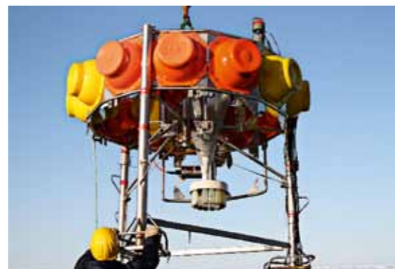
Abb. 1: Aufnahme eines benthischen Freifallgerätes mit einer Sedimentfalle zur Messung zeitlicher Variation im Sinkstoffeintrag in die Tiefsee
