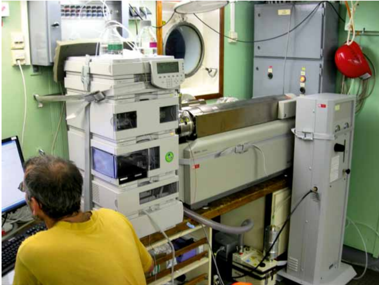
Abb. 21: Das Massenspektrometer an Bord zum direkten Aufspüren auch kleinster Toxinmengen
