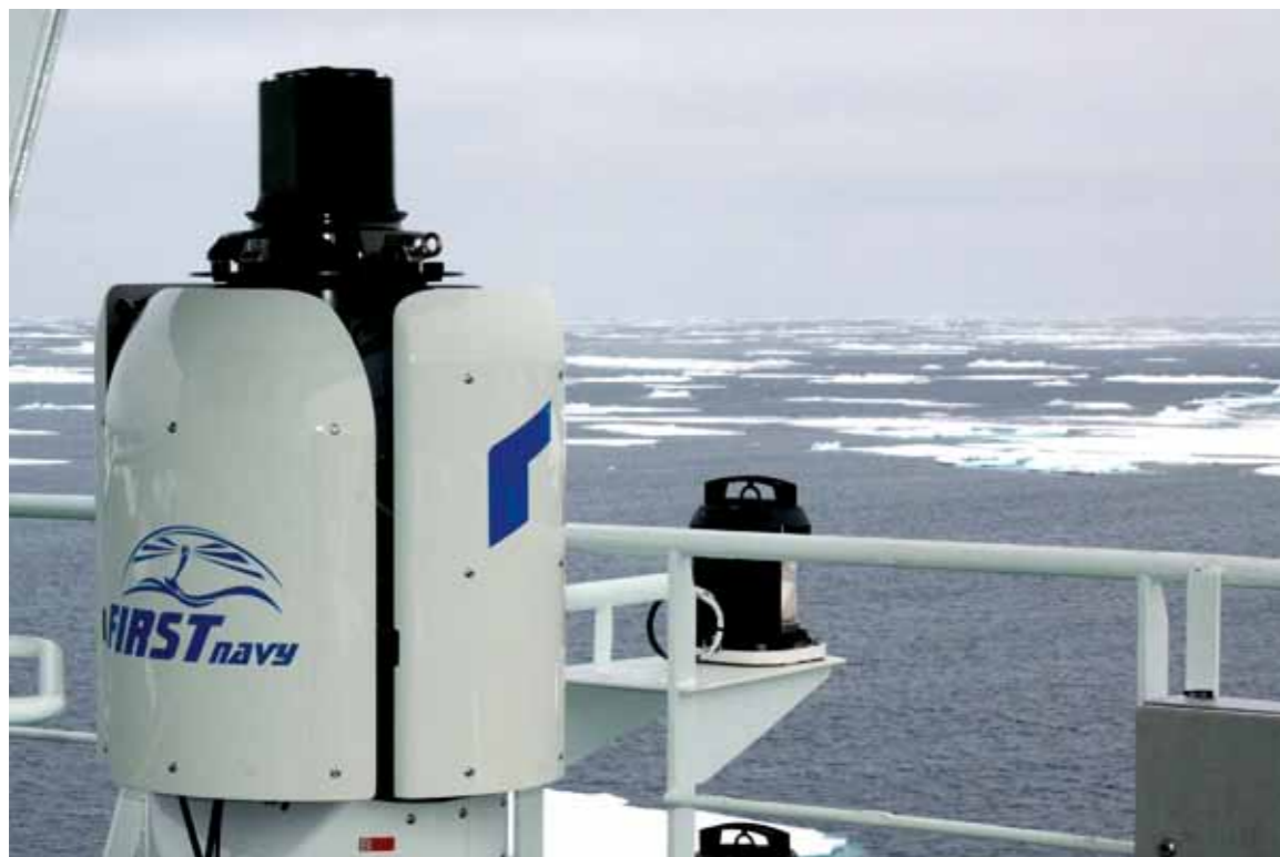
Abb. 3: Der FIRST Navy Wärmebildgeber ist im Krähenest in einer Höhe von ca. 28 Metern über dem Wasser auf einer hochstabilisierten Plattform (weiße Basis) installiert. Der Sensorkopf (grün) rotiert mit 5 Umdrehungen pro Sekunde. Durch die Aufbauten von ‚Polarstern‘ entstehen im Krähenest oft sturmähnliche Windbedingungen, während die Temperaturen auf bis zu minus 30 °C sinken können, was höchste Anforderung an das System bedeutet.
