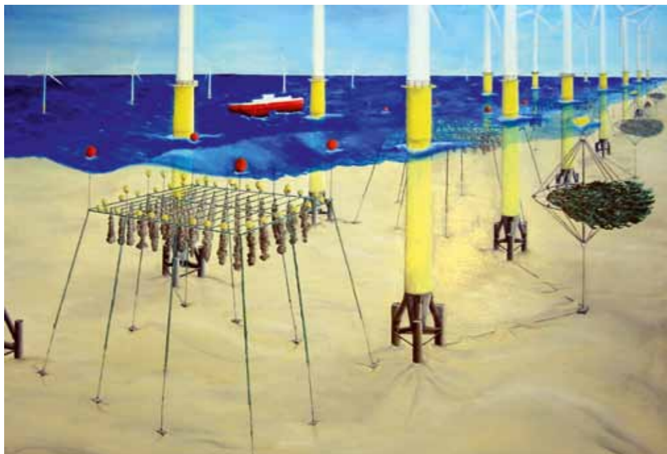
Abb. 1: Mögliche multifunktionale Nutzung von Gründungsstrukturen der Offshore-Windenergieanlagen mit Aquakulturkonstruktionen. Alternative Mehrfachanschlussmöglichkeiten könnten Muschelkollektoren an Langleinensystemen im Zentrum des Parks oder schwimmenden Ringsysteme für Algenzucht sein. Die Ringe könnten beim Bau oder bei der Wartung der Turbinen untergetaucht werden.
