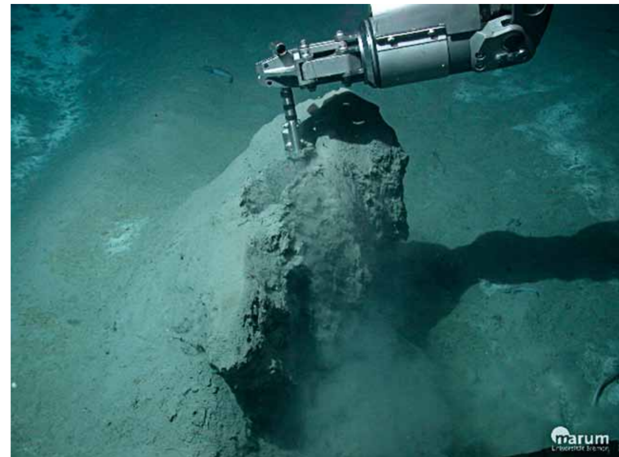
Abb. 2: Temperaturmessung an Gashydrat-Hügeln in der Nähe des LOOME-Schlammvulkanobservatoriums
