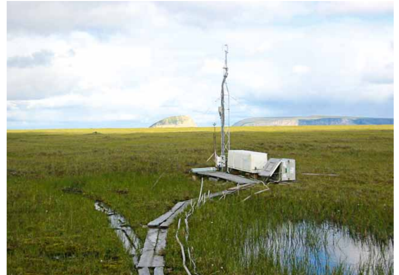
Abb. 1: Eddy-Kovarianz Messsystem zur Bestimmung der vertikalen CO 2 und Methanflüsse zwischen Boden und Atmosphäre.
