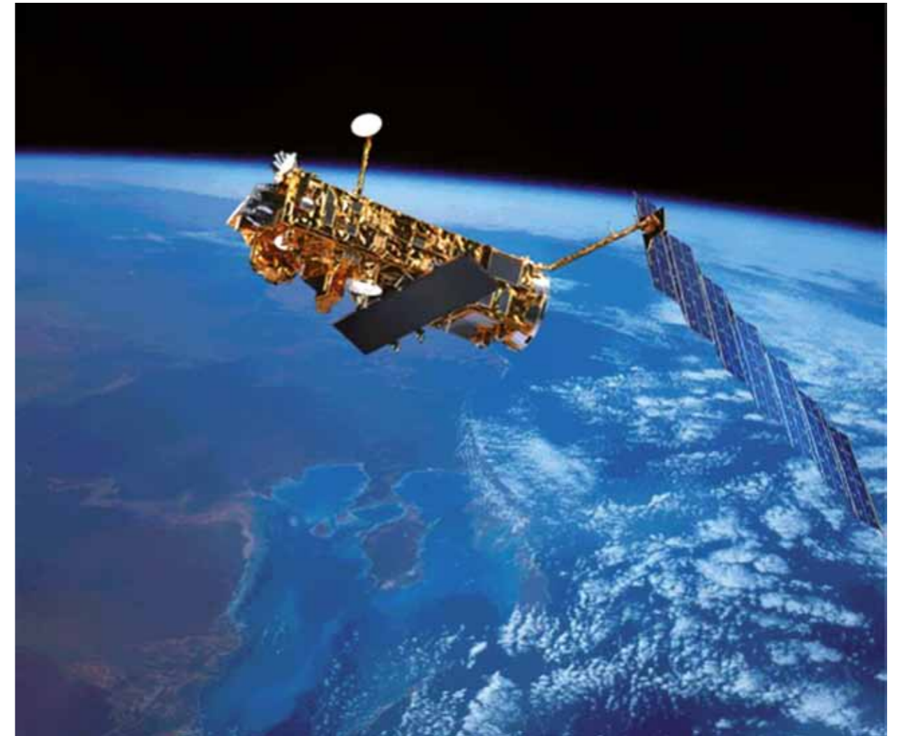
Abb. 8: Der Umweltsatellit ENVISAT, auf dem der Sensor „Sciamachy“ die Farbe des Ozeans detektiert.
