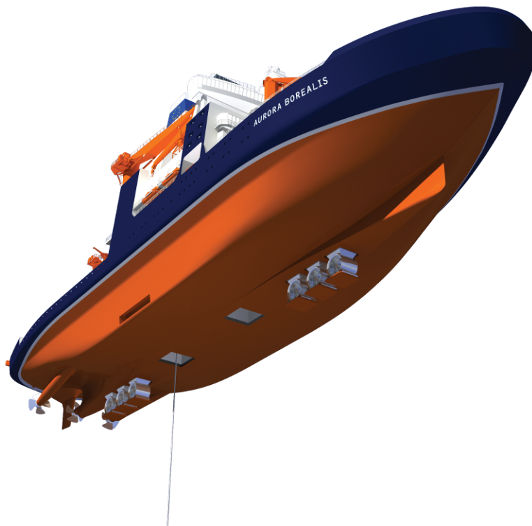
Abb. 21: Spezielle Rumpfform mit Vortriebs- und Querstrahleinheiten
