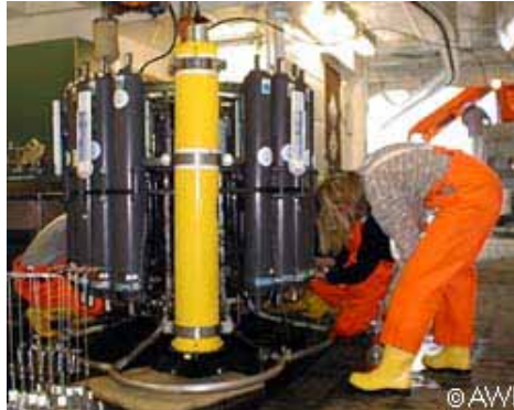
Abbildung 3.8.: Eine CTD-Rosette mit Wasserschöpfern, wobei das Gerät in der Mitte die CTD-Sonde ist.
