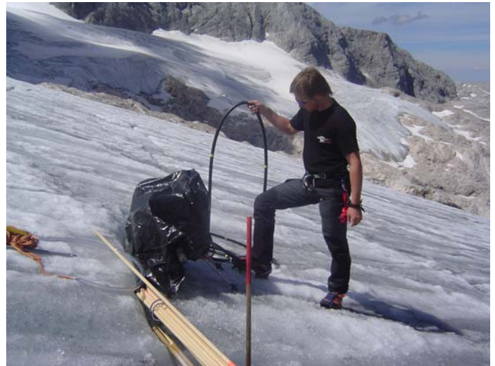
Abbildung 4.1b. Beim Pegelbohren auf der östlichen Zunge des Hallstätter Gletschers am 11.08.2008.
