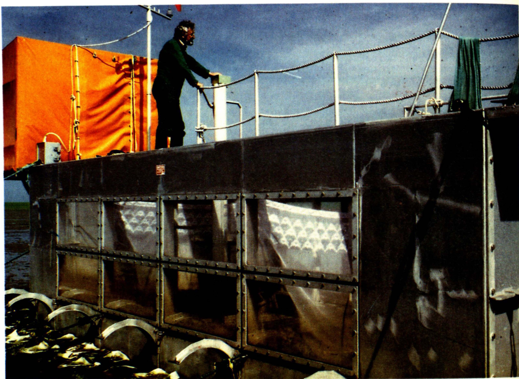
Abb. 2: Auch die Wissenschaft arbeitet mit Provisorien: 1985 diente Gardinengaze zur Abtrennung der einzelnen Versuchsfelder und damit gleichzeitig sowohl zum Einschluß der einzelnen epibenthischen Räuber auf die Versuchsfelder als auch zum Ausschluß unerwünschter räuberischer Arten (Foto: Farke).
