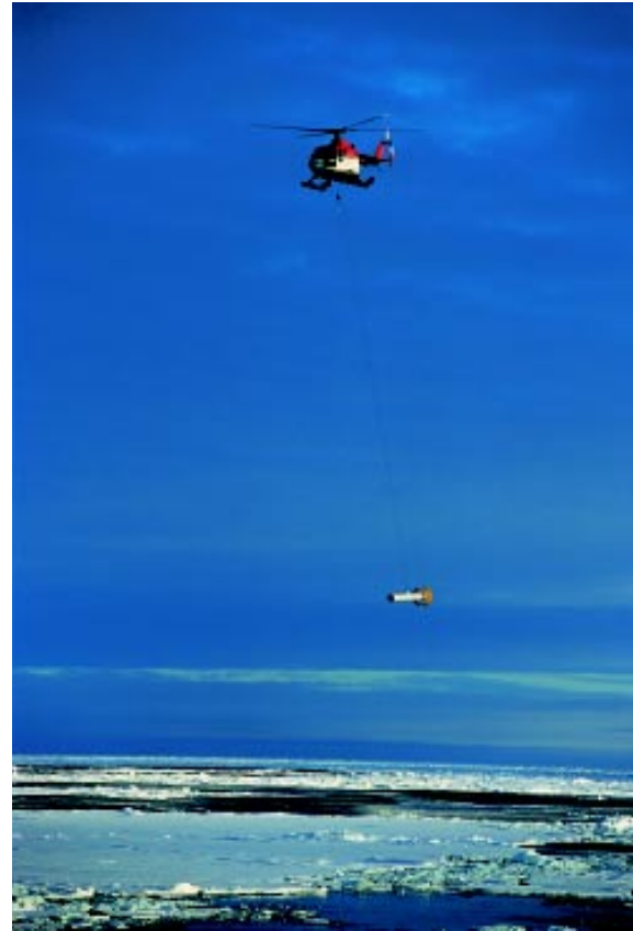
Abb. 5: Der EM-Bird wird zur Eisdickenmessung an einem zwanzig Meter langen Kabel unter einem Hubschrauber geschleppt.
