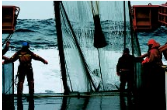
Das Krillnetz wird über das Heck eingeholt Rectangular midwater trawl at the aft of the RV 'Polarstern'
