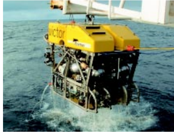
Abb. 34: ‚Victor 6000‘ – Der Unterwasserroboter des Forschungsinstitutes IFREMER (Frankreich)
