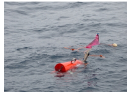
Abb. 2: Aufgetauchtes OBS. Neben der Flagge sind die Sender (Novatech) und Blitzler zu erkennen.
