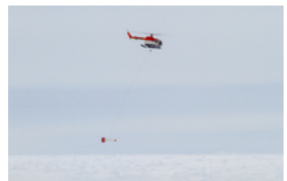
Abb.6: Eisdickenmessungen mit dem EM-Bird über antarktischen Meereis (© Martin Schiller)
