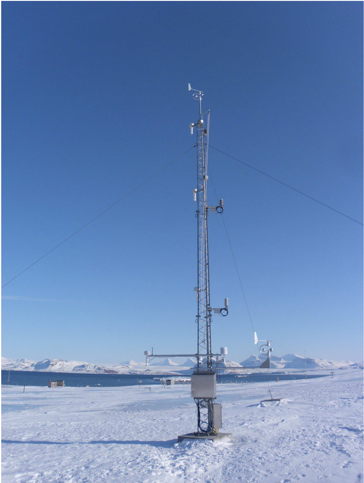
Abb. A-3: BSRN-Wettermast in Ny-Ålesund
