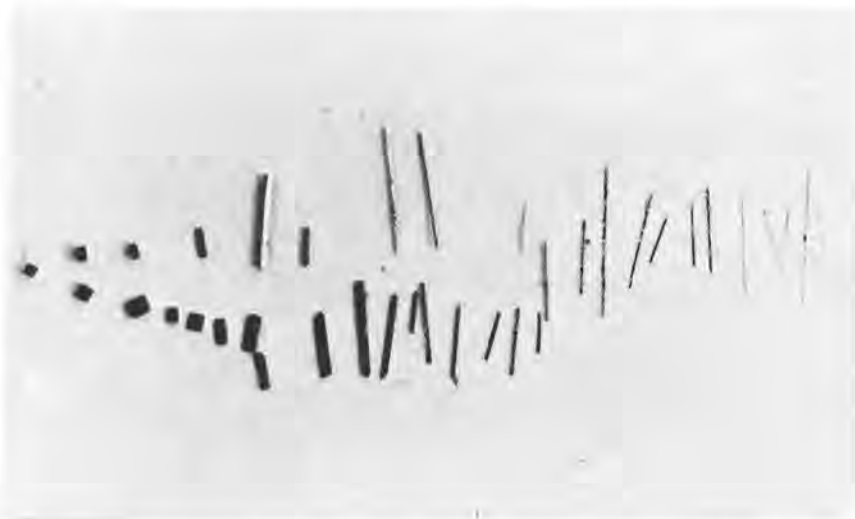
Abb. 3. Aus dem Marmor herausgelöste Pyritkristalle von sehr verschiedenem Habitus. Man beachte, daß die dünnen Nadeln alle gerade sind (längste Nadel ca. 3 mm).
