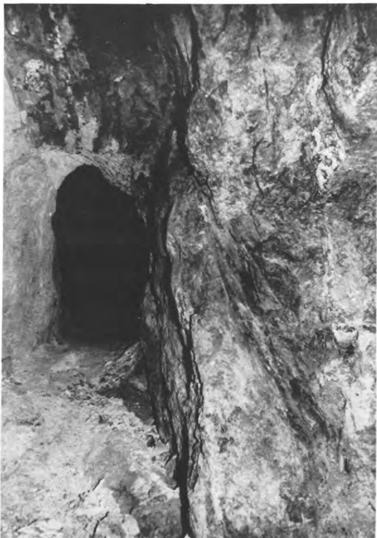
Abb. 3. Stollen von „Halle“ 5 nach Punkt 10 (Abb. 2); links über dem Stollen der Hauptgang anstehend, rechts abscherende Gangteile mit Baryt (weiß) und violetter Fluorit (schwarz)
