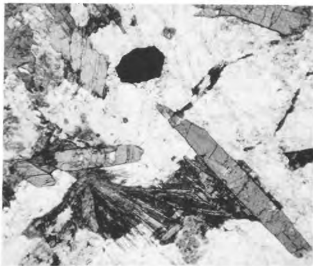
Abb. 10. Alkalisyenitgang. Stbr. am Michelsberg. Große Nadeln von anophoritischer Hornblende mit aufgewachsenen Büscheln von Ägirin im Sanidin. Vergr. 60 mal, Dünnschliff.
