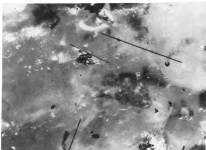
Abb. 4c) Die ganze Lamelle ist freigelöst und liegt jetzt gerade auf der Oberfläche. Das eine Stück ist nochmal durchgebrochen, so daß jetzt 3 Lamellenteile daliegen. Das mittlere Stück liegt hochkant, darum erscheint es dünner.
