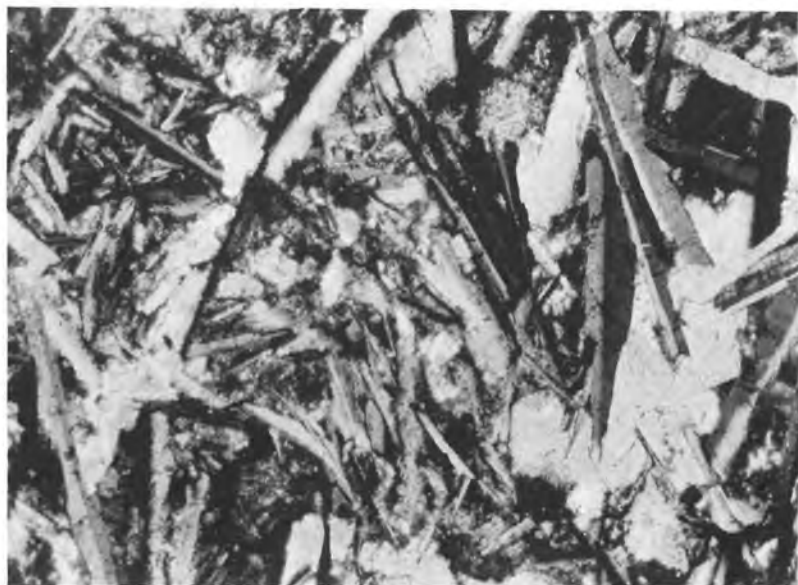
Abb. 9. Alkalisyenitgang. Fachwerk von meist nach dem Karlsbader Gesetz verzwilligten Sanidintafeln. Stbr. am Michelsberg. Dünnschliff + P. Vergr. 128 mal.
