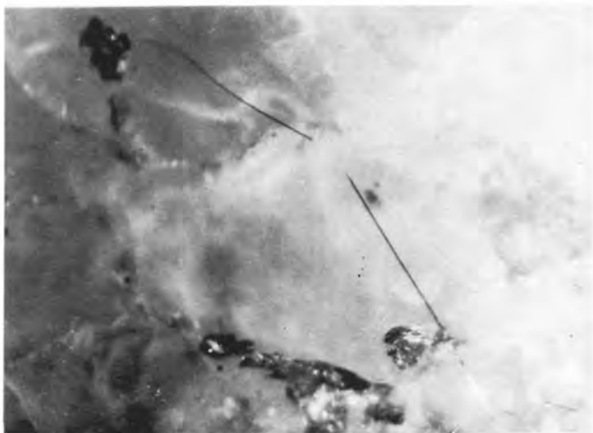
Abb. 4b. Marmorfläche mit verd. HCl angelöst, bis der mittlere Teil der Pyritlamelle frei geworden ist. Die Lamelle ist durch das starke Sprudeln der Säure in der Mitte durchgebrochen. Man kann deutlich das gerade Aufrichten der beiden Teile erkennen, die mit ihren Enden noch im Marmor stecken.
