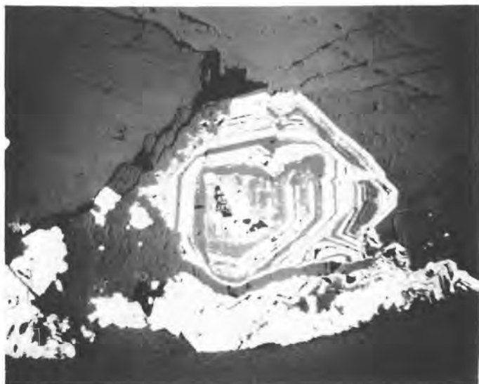
Abb. 1. Speiskobalt (Skutterudit), Nieder-Ramstadt, Vergr. 20 \times . Der Speiskobalt ist extrem zonar durch Weglösung der Nebenkomponten I und II und Ersetzung durch Calcit.
