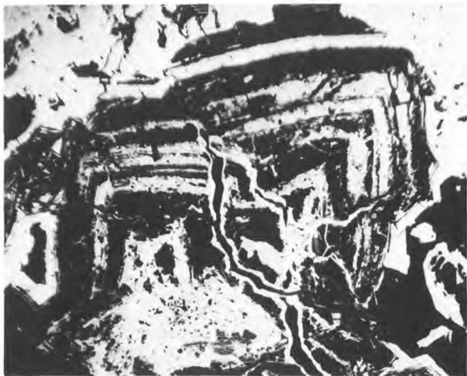
Abb. 2. Speiskobalt (Skutterudit), Nieder-Ramstadt, Vergr. 250 \times , Imm. Speiskobalt mit weggelöstem I und II. Die weggelösten Zonen sind großenteils mit Kalkspat gefüllt. Die Begrenzung einiger feiner Sprünge besteht aus Safflorit, ebenso die Partien in der Nord-Ost und Nord-West-Ecke.
