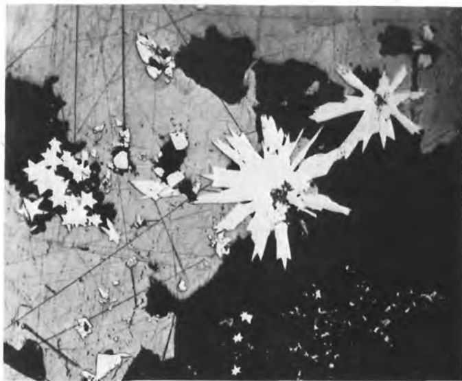
Abb. 4. Saffloritsternchen in Bleiglanz. Nieder-Ramstadt, Vergr. 250 \times , Imm., daneben stark verkratzt Silberglanz und etwas Zinkblende. Gangart schwarz
