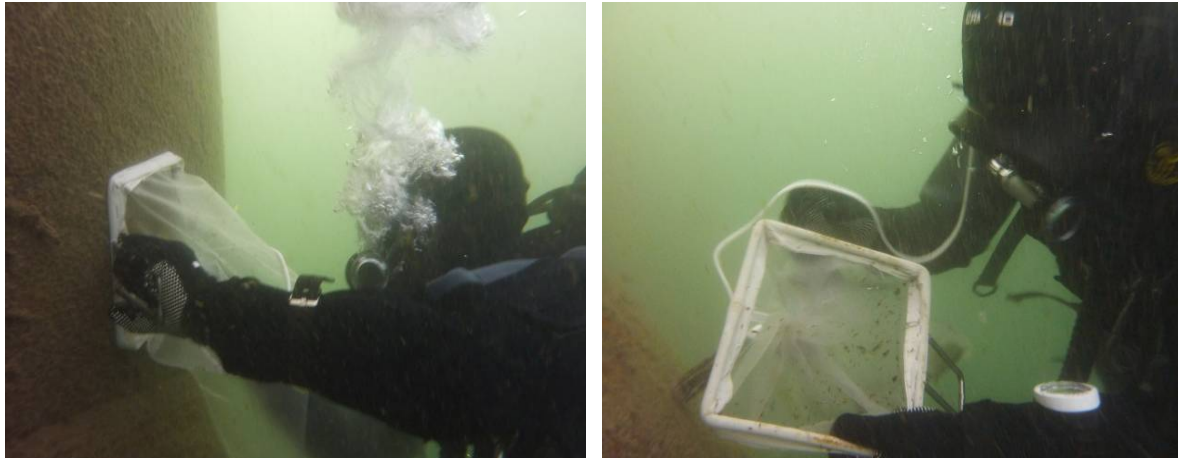
Abbildung 5: Links: Quantitative Beprobung der Epifauna auf der Gründungsstruktur einer Offshore-Windenergieanlage im Taucheinsatz. Rechts: 20 x 20 cm Rahmen mit Netzbeutel und Spachtel.
