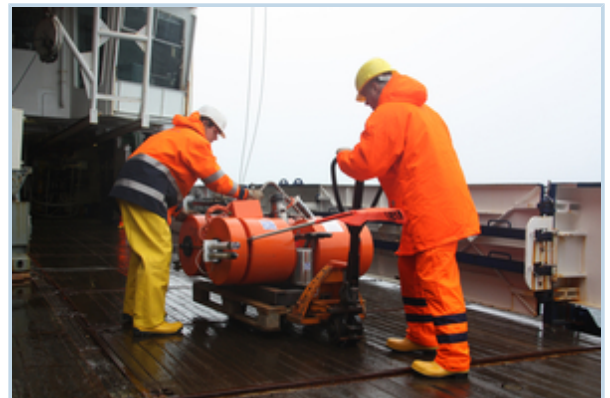
Mannschaft und Forschung schieben das Ozeanbodenseismometer (OBS) aufs Arbeitsdeck. Foto: Folke Mehrtens, Alfred Wegener Institute
