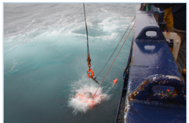
Auf zum Meeresgrund! In einem Jahr können die Seismologen dieses OBS hoffentlich mit vielen Daten über Mikroerdbeben wieder bergen. Photo: Folke Mehrtens, Alfred Wegener Institute
