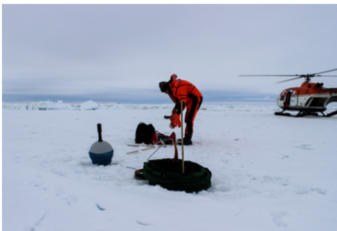
Abb. 1: Boje zur Messung der Drift von Meereisschollen. © Sandra Schwegmann (AWI)
