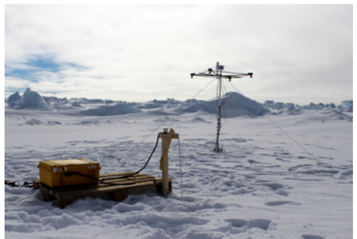
Abb. 2: Station zum Messen der Massenbilanz. Die Geräte messen das Eiswachstum, die Schneetiefe und deren Änderungen. © Sandra Schwegmann (AWI).
