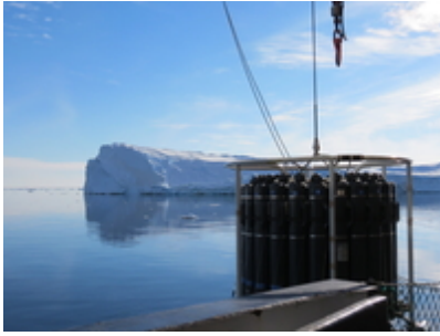
Abb. 3: Die CTD Rosette geht vor einem traumhaften Landschaftsbild zu Wasser. Das Gerät misst Wassertemperatur, Salzgehalt, Leitfähigkeit und sammelt Wasserproben aus unterschiedlichen Wassertiefen. © Svenja Ryan (CAU)
