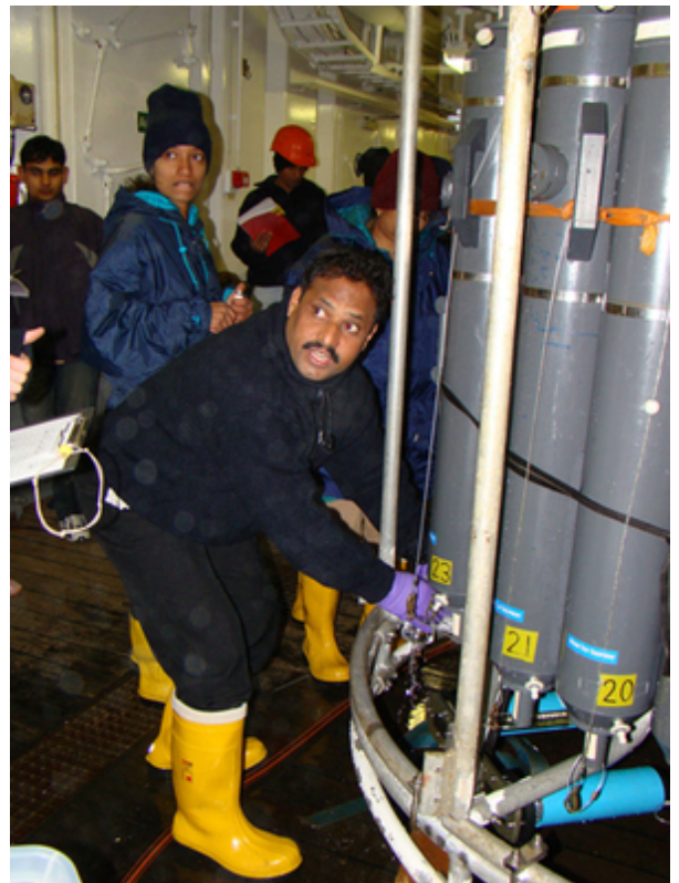
Wissenschaftler zapfen an Deck Wasserproben aus der CTD-Rosette. Foto: M. Ettlin, Alfred-Wegener-Institut
