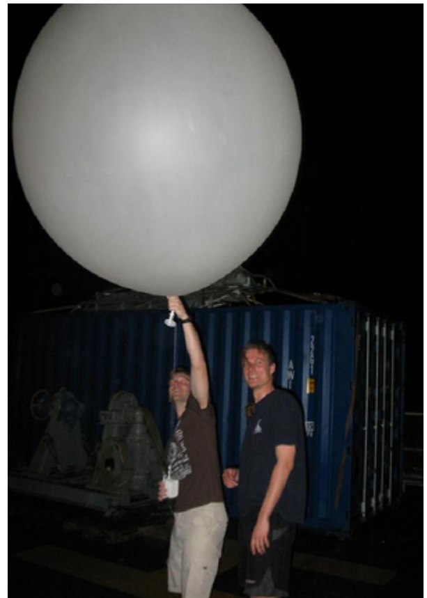
Nächtlicher Radiosondenstart. Während des Aufstiegs der Sonde bis in die Troposphäre werden meteorologische Daten per Funk ans Schiff übertragen. (© T. Hanschmann, IFM-GEOMAR)
