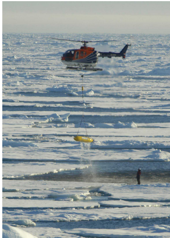
Bergung des autonomen Unterwasserfahrzeugs mit dem Hubschrauber aus dem Treibeis. (Foto: M. Jacob)
