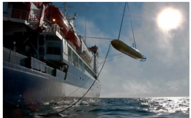
Aussetzen des autonomen Unterwasserfahrzeugs. (Foto: M. Ginzburg)
