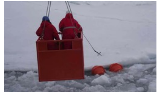
Nachdem das Verankerungsseil gerissen ist, werden die Auftriebskörper vom Personentransportkorb aus geborgen. (© A. Beszczynska-Moeller/AWI)
