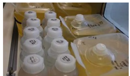
Große Wasserproben, in denen Neodym aufkonzentriert wird, um dessen Isotopenverhältnisse zu analysieren (© M. Zieringer, GEOMAR)
