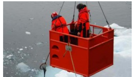
Einsatz des Personentransportkorbs, um den Algenteppich unterhalb der Eisschollen zu beproben (© K. Castro-Morales, AWI)
