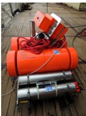
Abb 7 Das Ozeanbodenseismometer zurück an Deck nach seiner ersten erfolgreichen Mission (Quelle: V. Schlindwein AWI)
