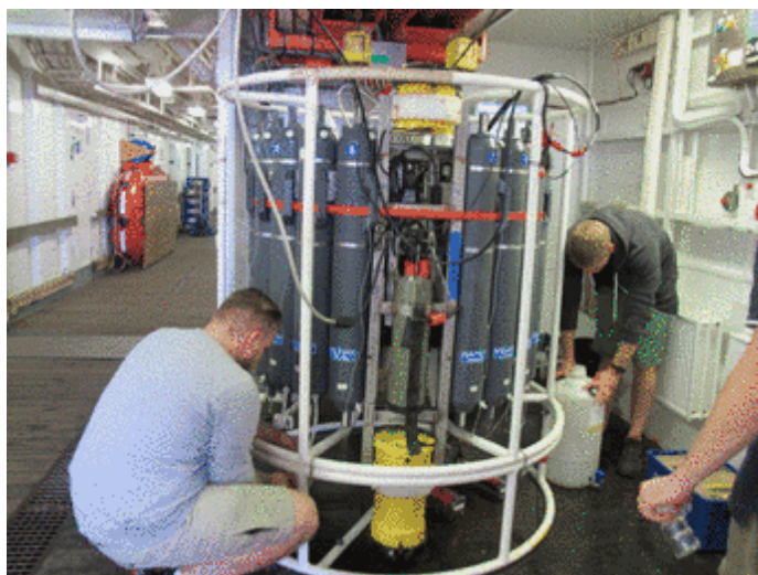
Fig. 6: Subsampling the water bottles by Thilo Klenz und Franz Philip Tuchen (Photo: S. Hanisch/AWI).
