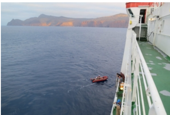
Abb. 5: Kalibrieren vor St. Helena: Das Schlauchboot zieht die Leine um den Bug von Polarstern herum (Foto: S. Hanisch/AWI).
