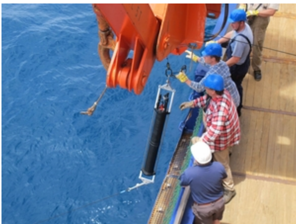
Abb. 4: Der "Stimmen-Recorder" zur Aufzeichnung von Walgesängen wird von Bootsmann René Schröter und seinem Team an Bord geholt. (Foto: S. Hanisch/AWI).
