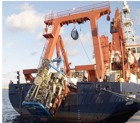
Abb. 7: Schemazeichnung des MeBo-Systems mit ausgeklappten Beinen auf dem Meeresboden (links); MeBo beim Ausbringen von FS METEOR (rechts).
