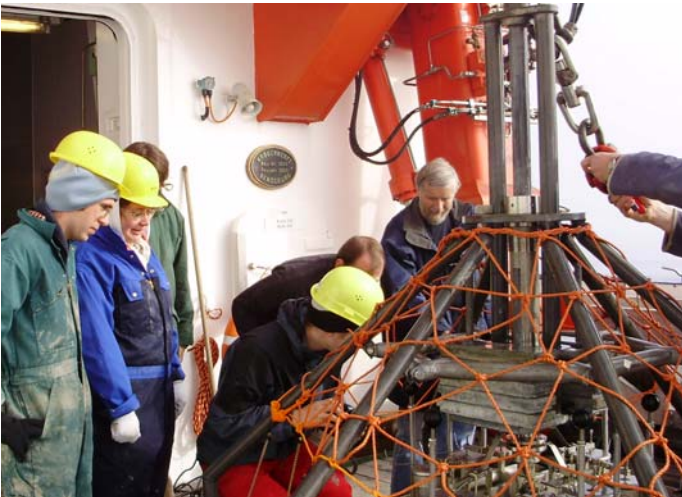
Der Multicorer zur Bergung ungestörter Sedimentoberflächen.
