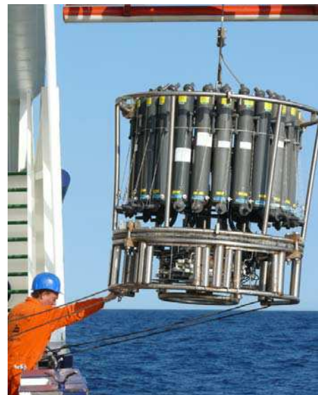
Ozeanographische Arbeiten in der Labradorsee: (Links) Das Auslegen der Verankerung K9. (Rechts) Das CTD (Conductivity-Temperature-Depth) Gerät des IFM-GEOMAR in Kiel in Einsatz.
