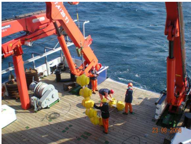
Ozeanographische Arbeiten in der Labradorsee: (Links) Das Auslegen der Verankerung K9. (Rechts) Das CTD (Conductivity-Temperature-Depth) Gerät des IFM-GEOMAR in Kiel in Einsatz.
