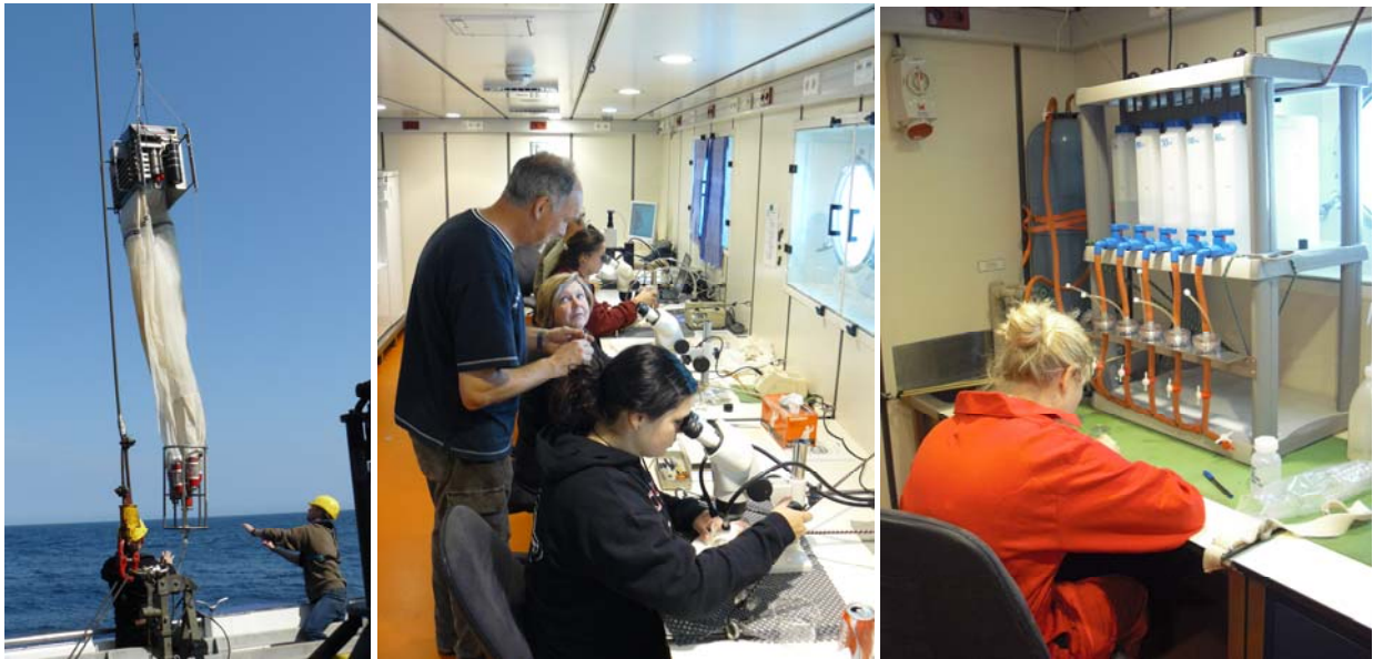
Die Beprobung des Planktons entlang des zweiten Schnittes in der Labradorsee: Das Tübinger Multischließnetz im Einsatz (links), das Auslesen von planktischen Foraminiferen aus den Netzfängen (Mitte) und die Filtration von Wasserproben aus der Schöpferrosette der CTD (rechts).
