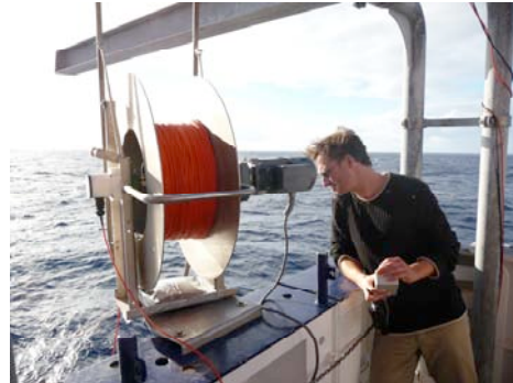
Tim Fischer bedient die Mikrostruktursondenwinde am Achterdeck.
