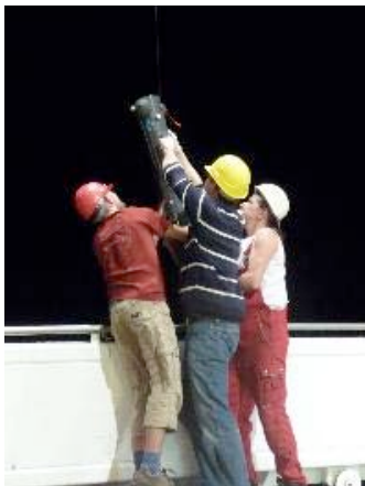
Die Spurenmetaller beim Einholen eines GOFLO Schöpfers.
