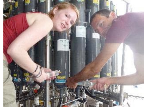
Maike und Severin nehmen Wasserproben in Glasspritzen zur Bestimmung des Tracers.
