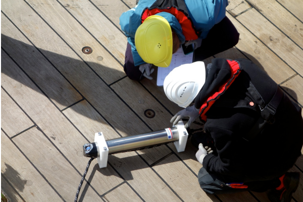
Akustischer Strömungsmesser aus der geborgenen Verankerung. © A. Schneehorst
