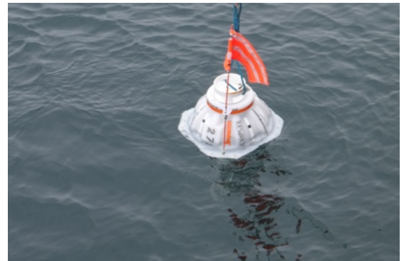
Inverted Echo Sounder (PIES) an Deck der Maria S. Merian und zum Testen im Wasser. © J. Stake
