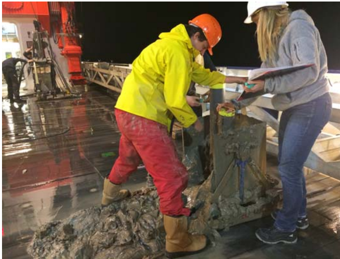
Abb. 3: Großkastengreifer mit Ablagerungen der Turbidites von 1929. Photo: Aggeliki Georgiopoulou
