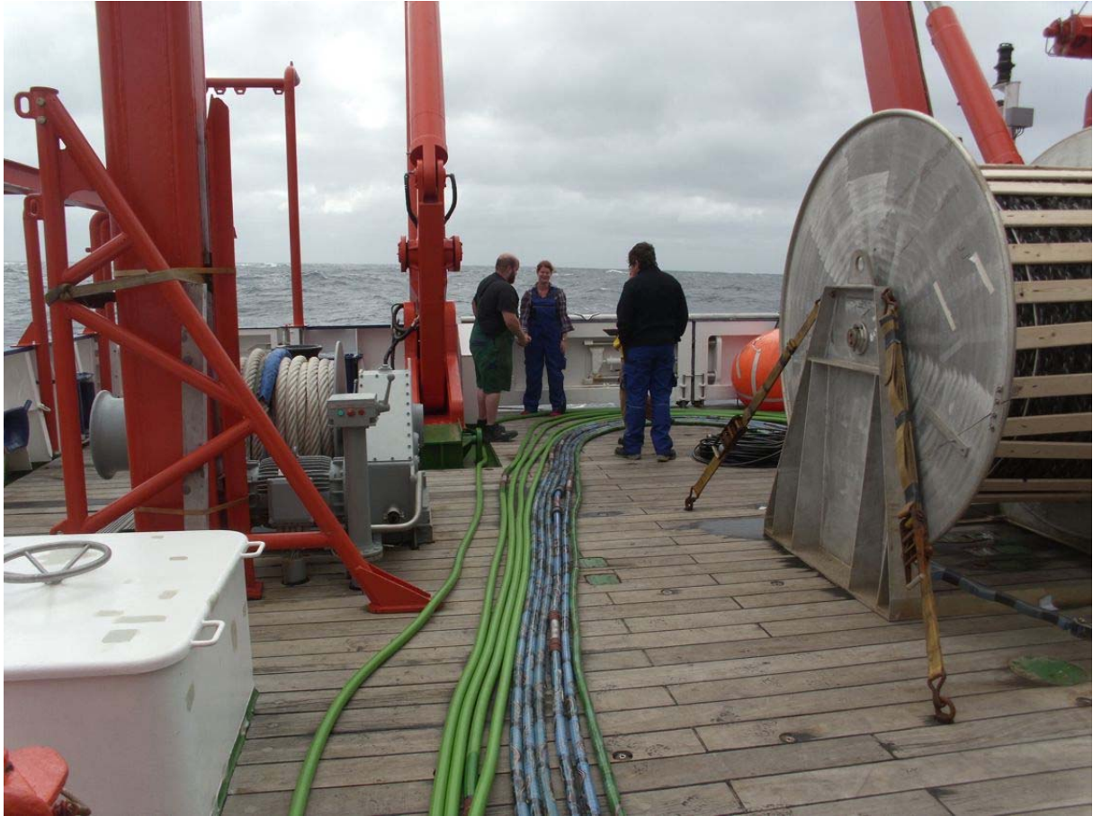
Vorbereitungen des Streamer auf dem Arbeitsdeck der Maria S. Merian
