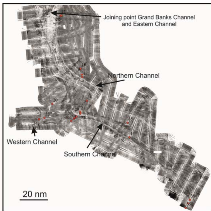
Abb. 2: Vorläufige Karte der akustischen Rückstreuung im südlichen Arbeitsgebiet. Helle Farben deuten auf grobkörnige Sedimente hin. Die roten Punkte zeigen die Lage der Kernstationen.
