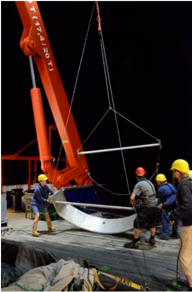
nächtlicher Einsatz des Isaac Kidd Midwater Trawls (IKMT)
