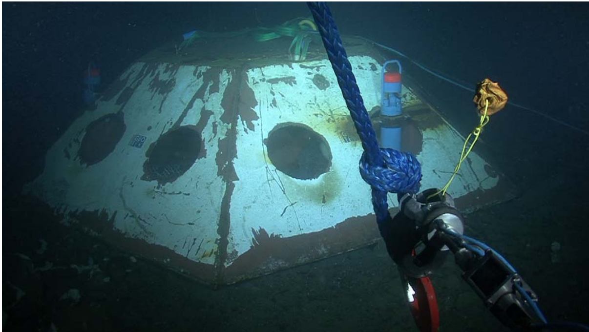
Abbildung 1: Im Vordergrund ist der Manipulatorarm von Jago zu sehen. Im Hintergrund steht das Observatorium mit verschiedenen Sensoren (Bild: Jago Team) noch auf dem Meeresboden.
