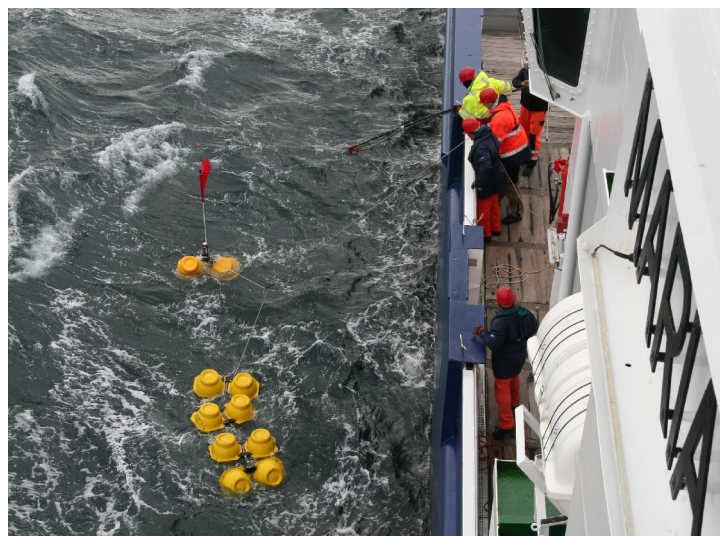
Beim Anpicken der Kopfboje der GFZ-Verankerung
