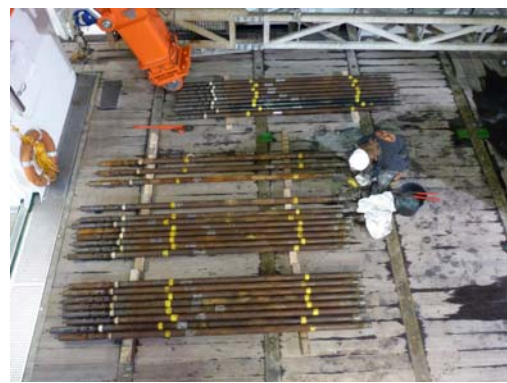
30 Corebarrels mit 70 m Kern auf dem Deck der Merian
