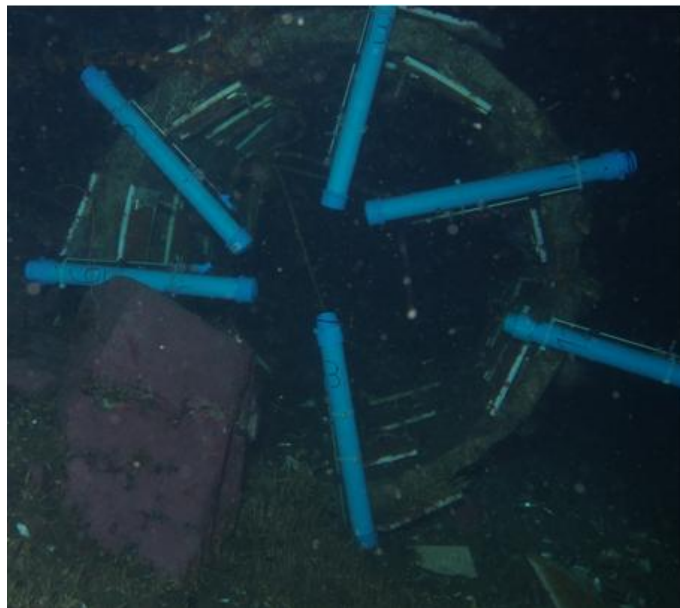
Abb. 10 Installierte Sedimentfallen an Röhre 3.
