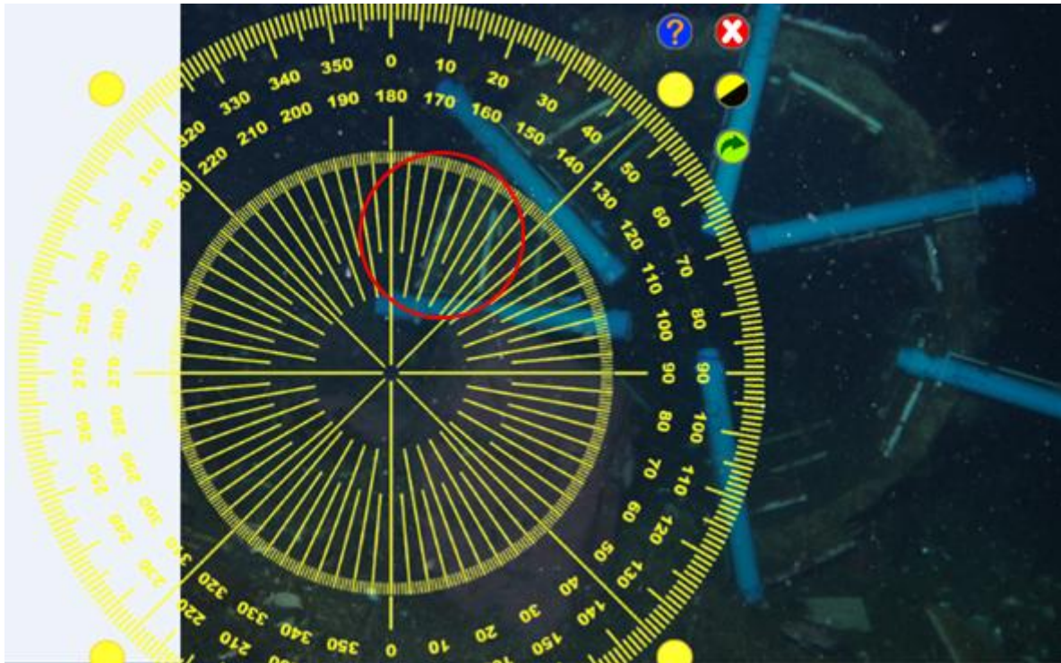
Abb. 5 Winkelmessung der Kachelposition 1a an Röhre 3 mit Hilfe des Kreiswinkelmessers 2.1.
