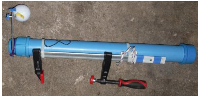
Abb. 9 Sedimentfalle Nr. 8 an Schraubzwinge befestigt, inklusive Gipsei.
