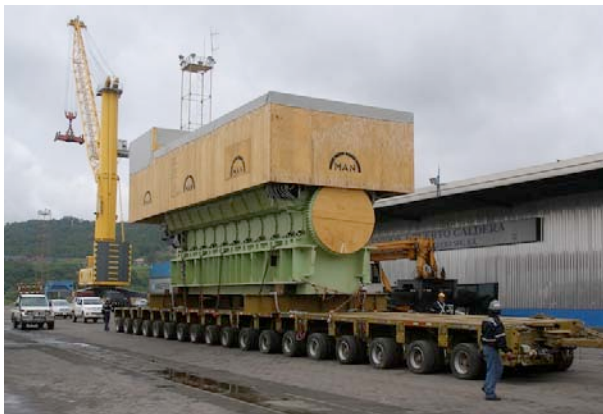
Dieselmotor aus Deutschland für ein costaricanisches Kraftwerk auf der Pier von Caldera.
