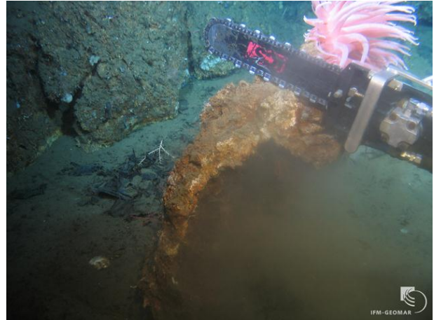
Abb. 2b: Anschneiden mit der Kettensäge.
