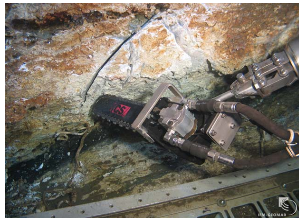
Abb. 2: Beprobung anstehender Karbonate mit der hydraulischen Kettensäge am ORION-Manipulator.
