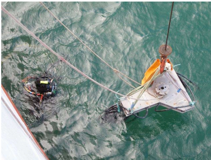
Taucher installieren das ELAC Nautik Fächerecholot
