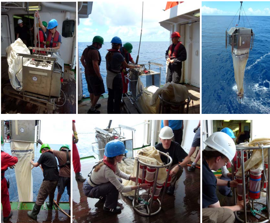
Das Multischließnetz wird vom Deck eingesetzt. Dafür müssen erst die Auslöser der Netze gespannt werden und der Einleiterkabel angeschlossen. Danach kann das Netz ins Wasser. Beim Einholen werden alle Netze gründlich mit Meerwasser gespült und dann am Deck die Fangbecher gewechselt.
