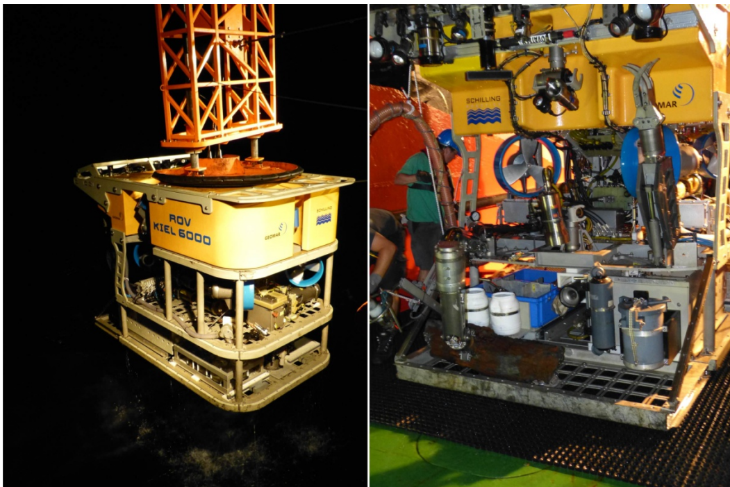
Das ROV Kiel 6000 des Geomar nach einem Einsatz im potenziellen deutschen Sulfid-Lizenzgebiet (nach Bergung eines großen inaktiven Sulfidschlotes, rechts)
