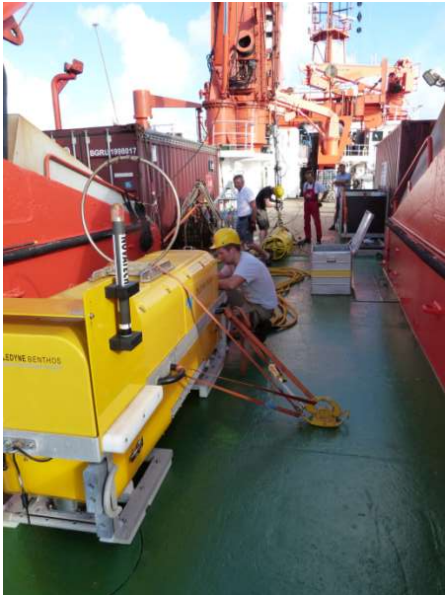
Vorbereitung des BGR-Seitensichtsonars vor dem ersten Einsatz.
