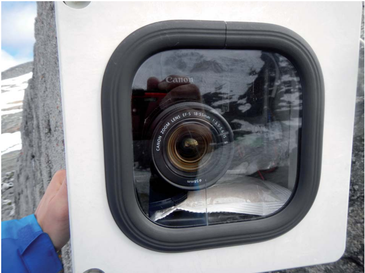
Abbildung A.4: Kamera 350 mit schadhaftem Glas, das am 28.08.14 getauscht wurde.
