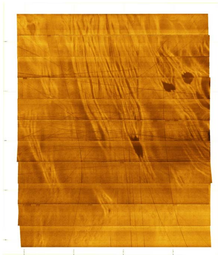
Side Scan Karte des DEA Gebietes. Insgesamt wurden 78 Störungen durch einen Pflug herbeigeführt, von denen die meisten identifiziert werden können. Diese Karte wird unser Beprobungs-Leitfaden für die nächsten drei Wochen sein.
