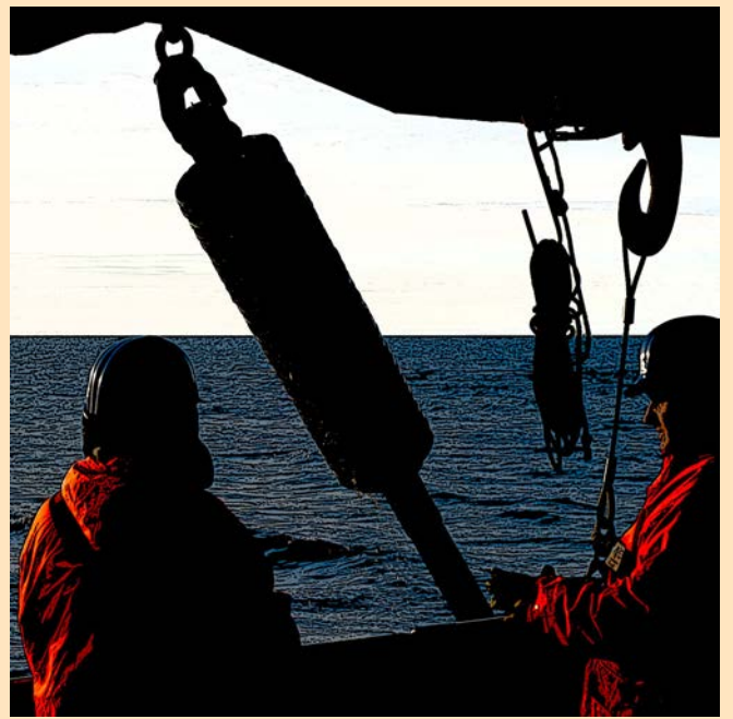
schwerelot an deck - aber nix drin
