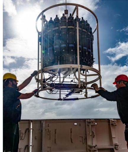
Station M151-2 beim Aussetzen der CTD mit kurzzeitigem Sonnenschein.
