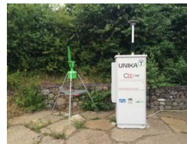
Pollenmessstation in Augsburg zur Untersuchung des Einflusses anthropogener Luftschadstoffe auf die Allergenität von Birkenpollen (Foto: C. Traidl-Hoffmann, UNIKA-T).
