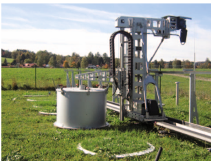
Automatisches Treibhausgas-Messsystem am Voralpen-Standort Rottenbuch (Foto: R. Kiese, KIT IMK-IFU).
