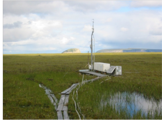
Beobachtungssystem für zeitlich hochauflösende Messungen der Spurengasflüsse zwischen sibirischer Tundra und der Atmosphäre im Lenadelta, Sibirien (Foto: T. Sachs, GFZ).
