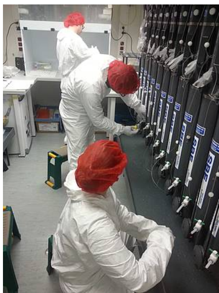
Abb. 1: Metallfreie Probeflaschen werden in den Reinraum gebracht um unter saubersten Bedingungen die Spurenmetalle zu beproben. (Foto: Jaw Chuen Yong)
