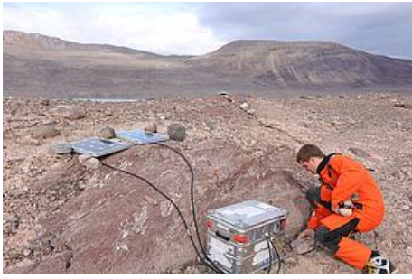
Abb. 2: Aufbau der Station CENT am Centrumssø. Im Hintergrund ist die GNSS Antenne und im Vordergrund zwei Solarpanele und die Zarges-Box mit GNSS-Receiver, Batterie und Laderegler zu sehen. (Foto: Benjamin Ebermann)
