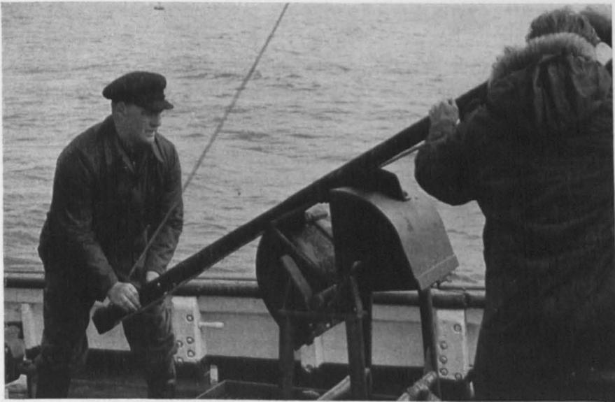
Abb. 1. Zur Entleerung geöffneter Backengreifer nach VAN VEEN (1936). Der Greifer ist auf ein Gestell gesetzt, damit der Inhalt auf darunterliegende Auslese-Siebe fallen kann. An den beiden sich scherenartig überschneidenden Holmen — hier wirken sie wie ein durchgehendes Stück — wird der Greifer geschlossen. — Aufn. Dr. G. RICHTER.
