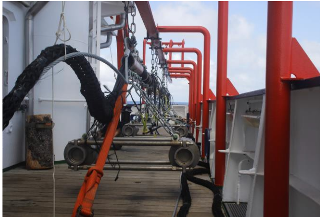
Backbordarray bestehend aus 6 Luftkanonen
