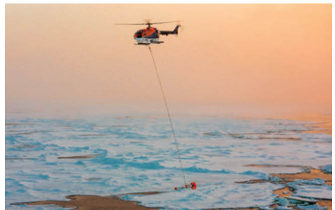
Für großflächige Vermessungen der Eisdecke setzen AWI-Forscher ihren Meereisdickensensor EM-Bird ein. Er wird auf diesem Foto von einem Bordhubschrauber des Eisbrechers Polarstern in 15 Metern Höhe über das arktische Meereis geschleppt. (Foto: S. Hendricks, AWI)
